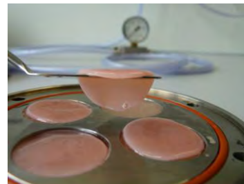
Stabile Patches nach der Verdichtung
